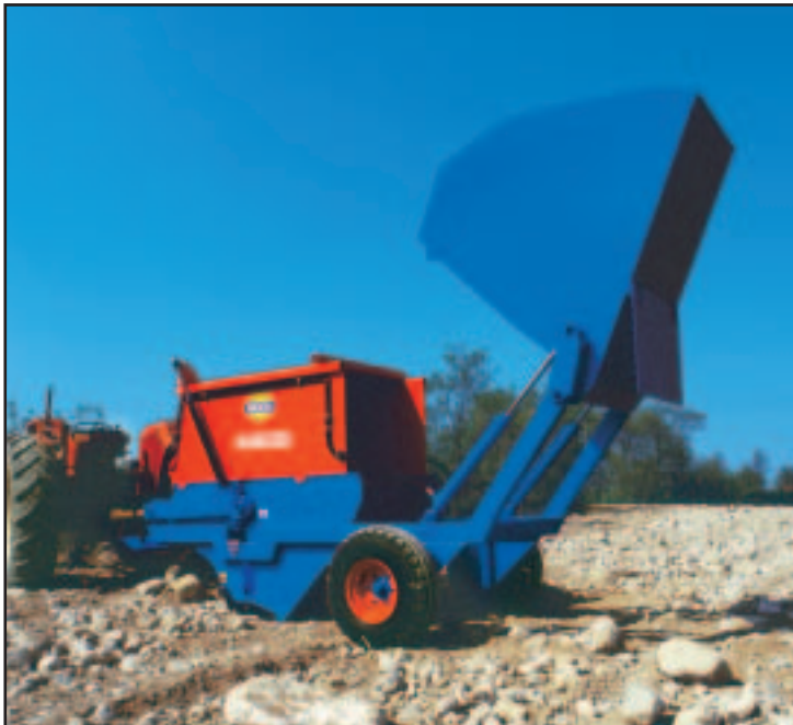
RST/250-S anche con ruote posteriori traslabili idraulicamente per lo spietramento in vigneti e frutteti.
